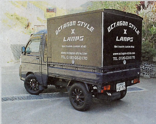
アルミフレームと樹脂パネルでできた荷台のコンテナ(写真上)。扉には会社のロゴなどを入れられる 一 大月市大月町花咲
